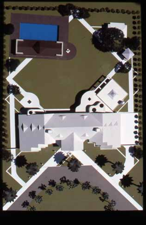
サンマリノの家の模型。2階建ての家となったが、両隣の家が1階建てだったので街並みのハーモニーとスケール感を合わせるために両サイドの屋根を1階まで下げた。1990年設計
